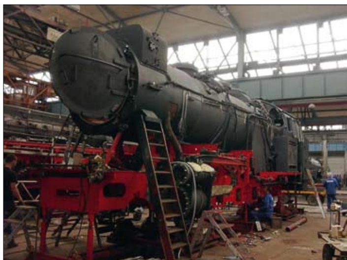
In den Hallen des Meininger Dampfloswerkes: Gründliche Hauptuntersuchung an einer Dampflokomotive der HSB. Fotos: Sammlung HSB
