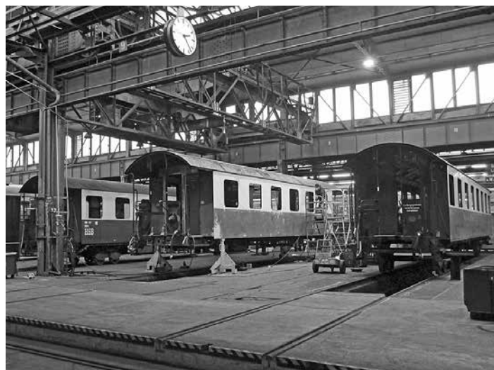
Blick in die große Halle des Dampfloswerks Meiningen: Vier Reisezugwagen der HSB befinden sich dort derzeit in der Hauptuntersuchung.
