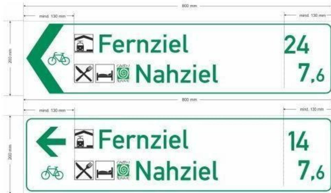
Abbildung 8: Standardmaße für Zielwegweiser 8
