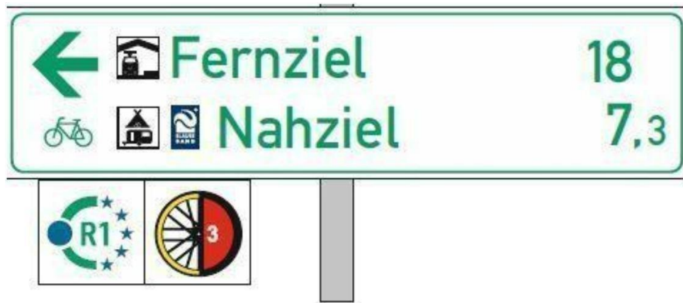
Abbildung 11: Tabellenwegweiser mit Routenplaketten 12
